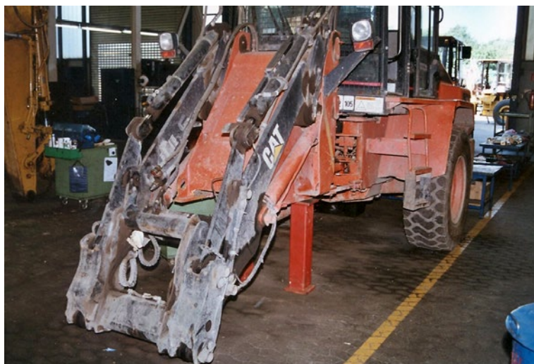
Abb. 33 Unterbaugestell bei Arbeiten am Radlader
