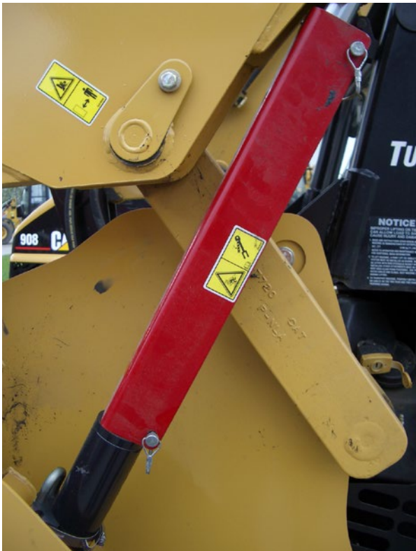
Abb. 41 Stützeinrichtung in Position an einer Erdbaumaschine
