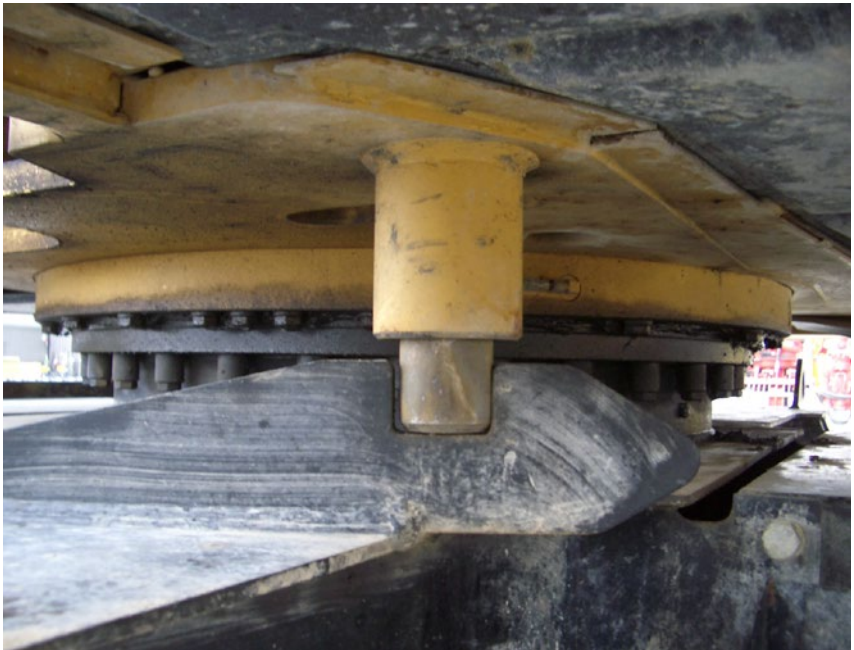
Abb. 40 Dreh Sperre an einem Hydraulikbagger in Sperrstellung
