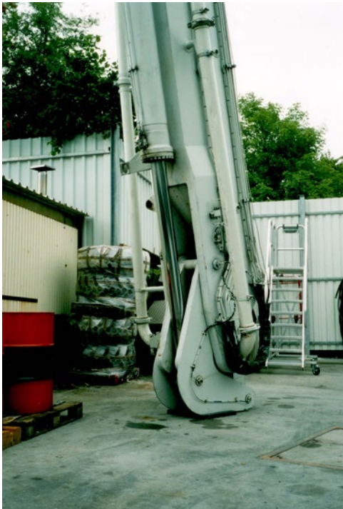
Abb. 38 Auf den Boden abgesenkter Ausleger einer Betonpumpe
