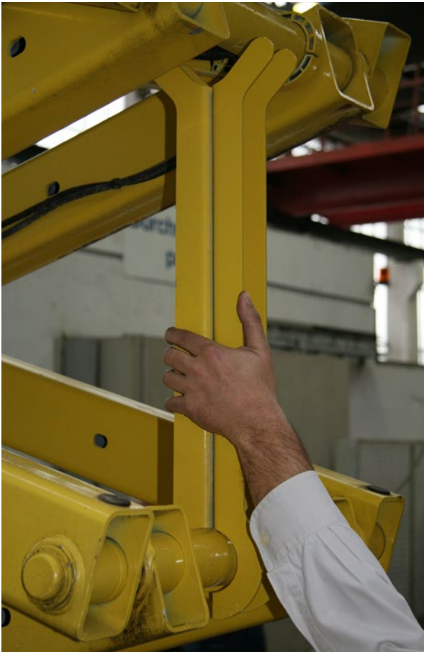
Abb. 29 Eingelegte Wartungsstütze an hydraulischer Scheren-Hubarbeits- bühne
